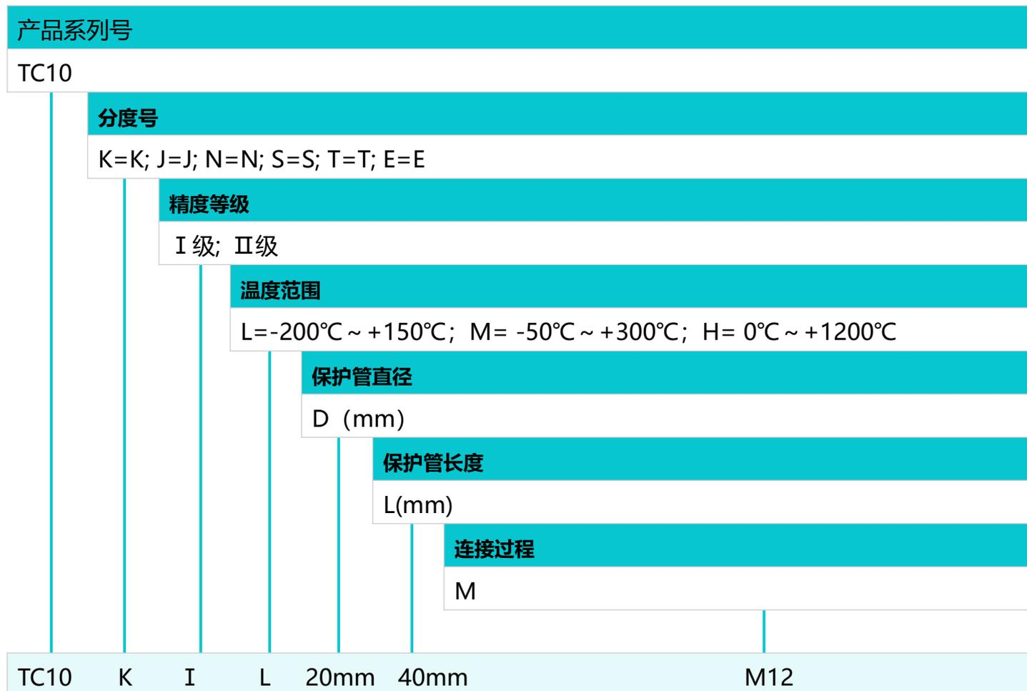
**选型说明：** TC10.KM.D6L100.G1/4 表示：TC10 系列，分度号：K 型，测温范围：-50 ~ +300°C，保护管直径 6mm，保护管长度 100mm，连接过程：固定 G1/4 螺丝。
