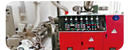
φ45 锥形双螺杆 φ45 taper double screw
