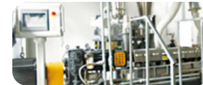
φ35 平行双螺杆 φ35 parallel double screw
