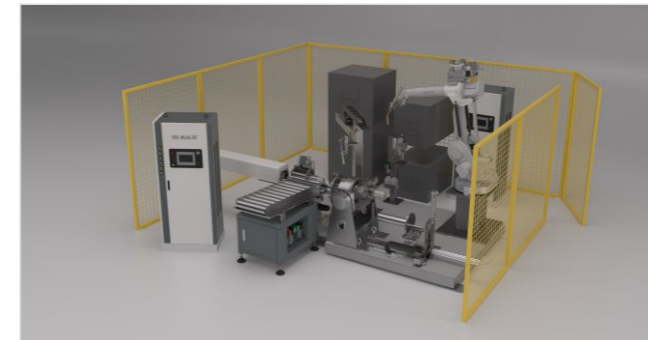
▼ 机器人轴销垫板焊接系统 Robot Shaft Pin Pad Welding System
