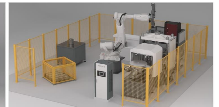
▲ 机器人电机定子焊接系统 Robot Motor Stator Welding System
