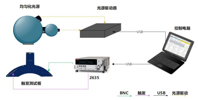
图表 8 硬件构成框图
