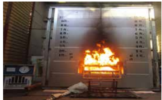
NFPA285 (评价包含易燃成分的非承重外墙火灾蔓延特性的标准试验方法)
