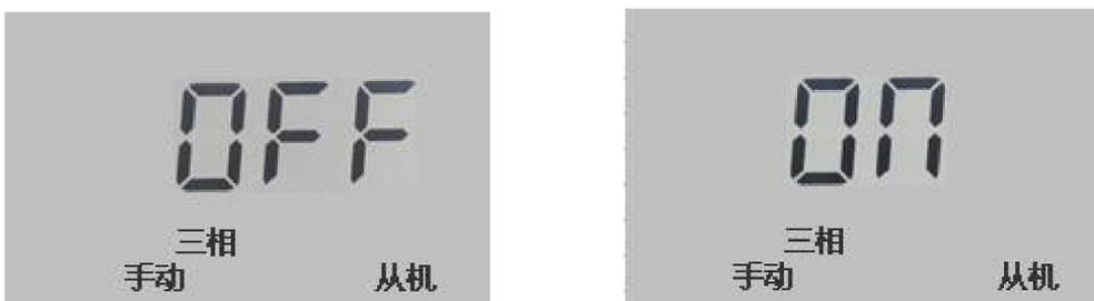
如显示为“OFF”，此电容为切除状态；显示为“ON”，此电容为投入状态；按“确认”键可以进行投、切转换。
