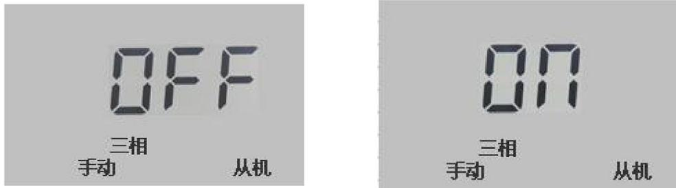
如显示为“OFF”，此电容为切除状态；显示为“ON”，此电容为投入状态；按“确认”键可以进行投、切转换。
