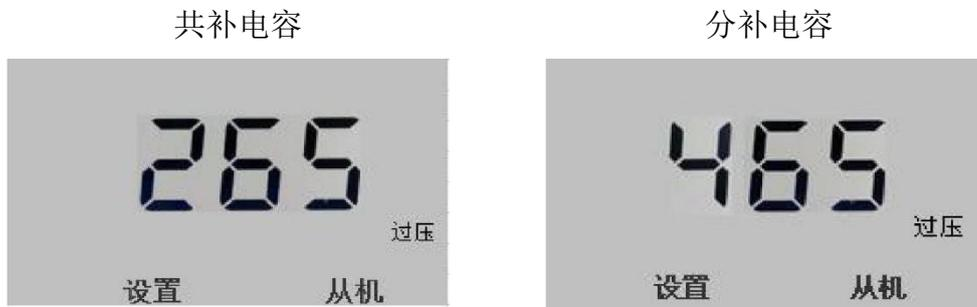
当检测到电压大于过压设置值时，显示“过压”提示。
