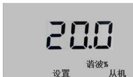
当检测到电压总谐波含量大于设置值时，显示“谐波”提示。
