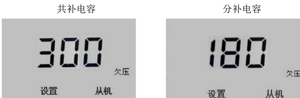
当检测到电压小于过压设置值时，显示“欠压”提示。
