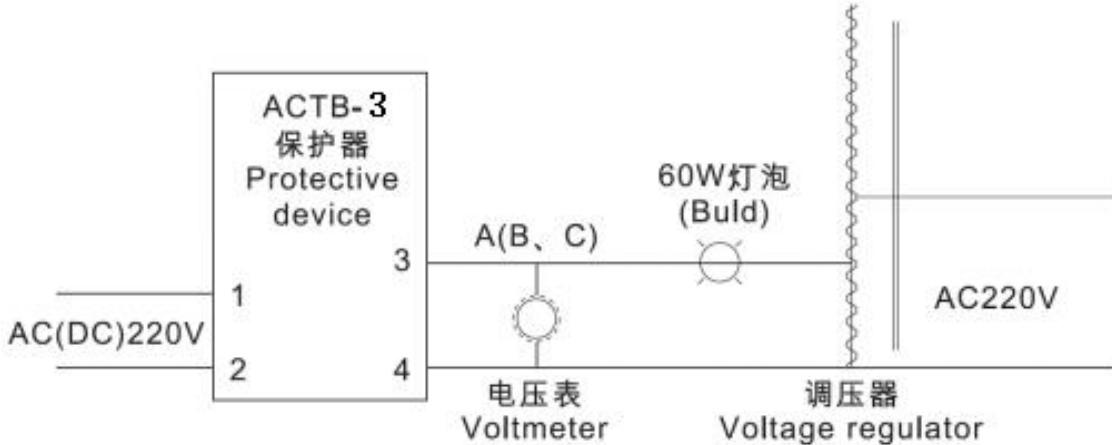
保护器在使用前应进行检测，用万用表电阻档测量输入端（3、4）时，电阻应大于  $100M\Omega$ 。
